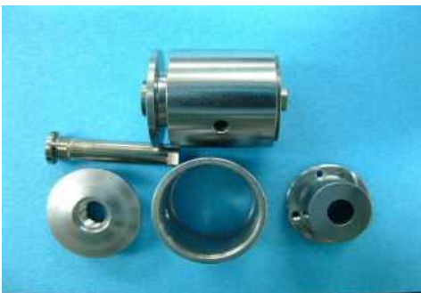
組合わせ部品 材質 Fe-Ni系
