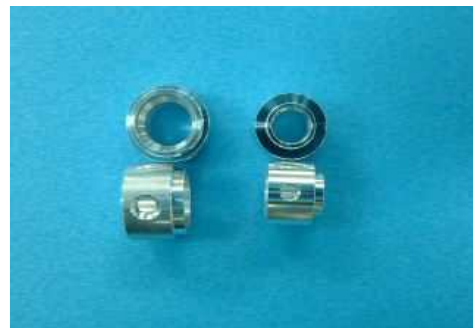
ファン取付けボス 材質 A5056
