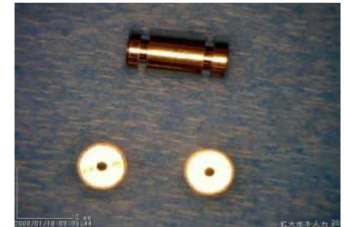
アルミ部品 貫通穴 0.5 材質 A2011
